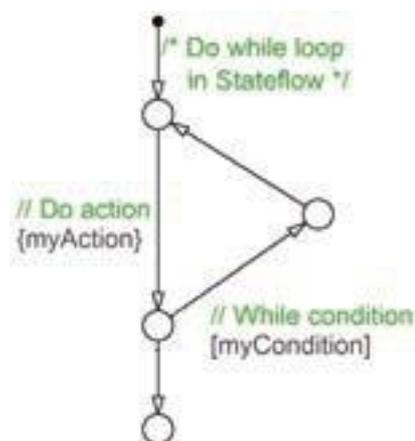
Рис. 2. Шаблон проектирования цикла с условием продолжения (do-while) в Stateflow
