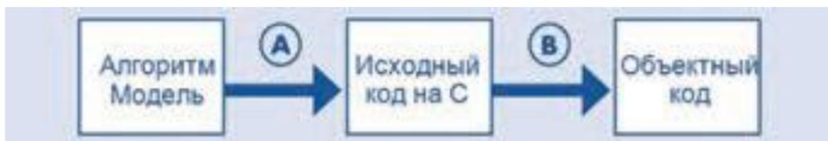
Рис.1. Рабочий процесс генерации кода в модельно-ориентированном проектировании
