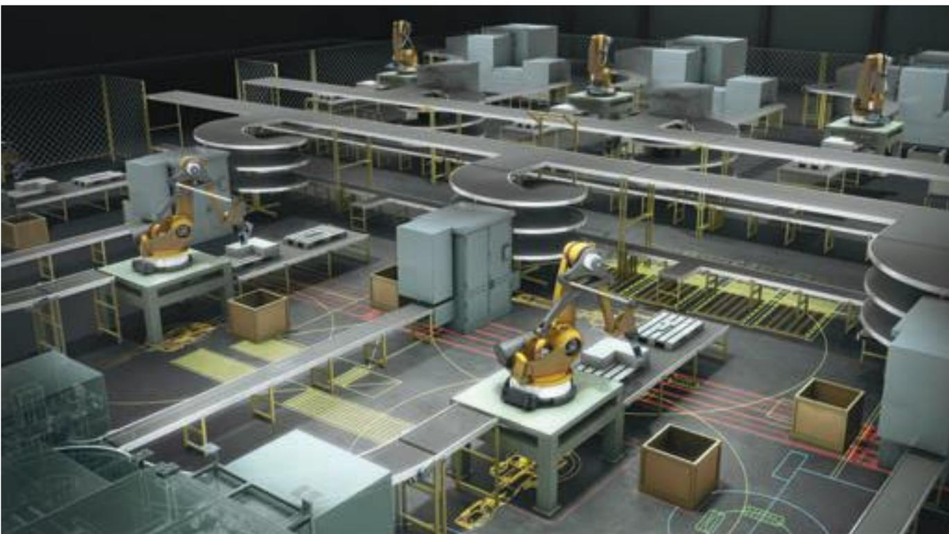
**Визуальная среда 2D- и 3D-компоновки.** Можно рассматривать альтернативные варианты компоновки, перемещая 3D-модели оборудования по 2D-плану этажа.
